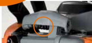
コイルスプリングを使用した防振構造を採用したことで、大幅に振動が低減しました。
